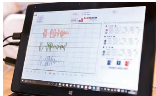
離れていてもロボットが呼吸・脈拍・ 体動を検知し、PCに波形表示する
