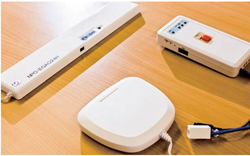
みまもりバイタルロボット2種 (写真左がベッドタイプ、中央が ルームタイプ)と、IoT端末(写 真右)
